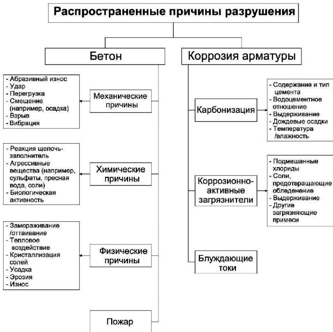
Рисунок 2.2 - Распространенные причины разрушений конструкций
